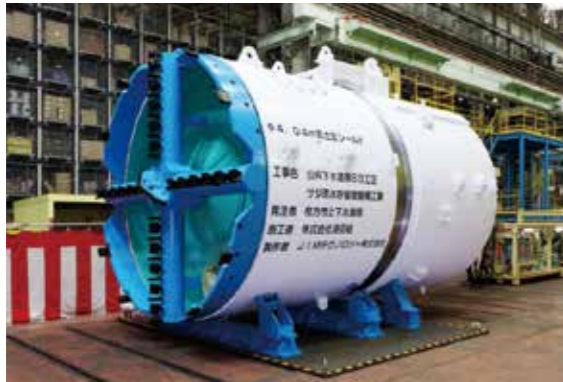
シールドマシン(雨水貯留管)
