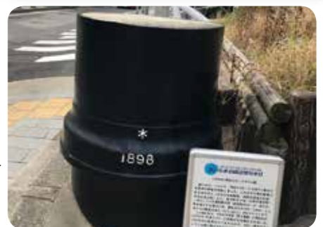
旧北野浄水場近くに展示されている「神戸市水道創設期導水管」。布引ダムから奥平野浄水場へと導水していた、実際の鑄鉄製の管(直径約60cm)の一部。
